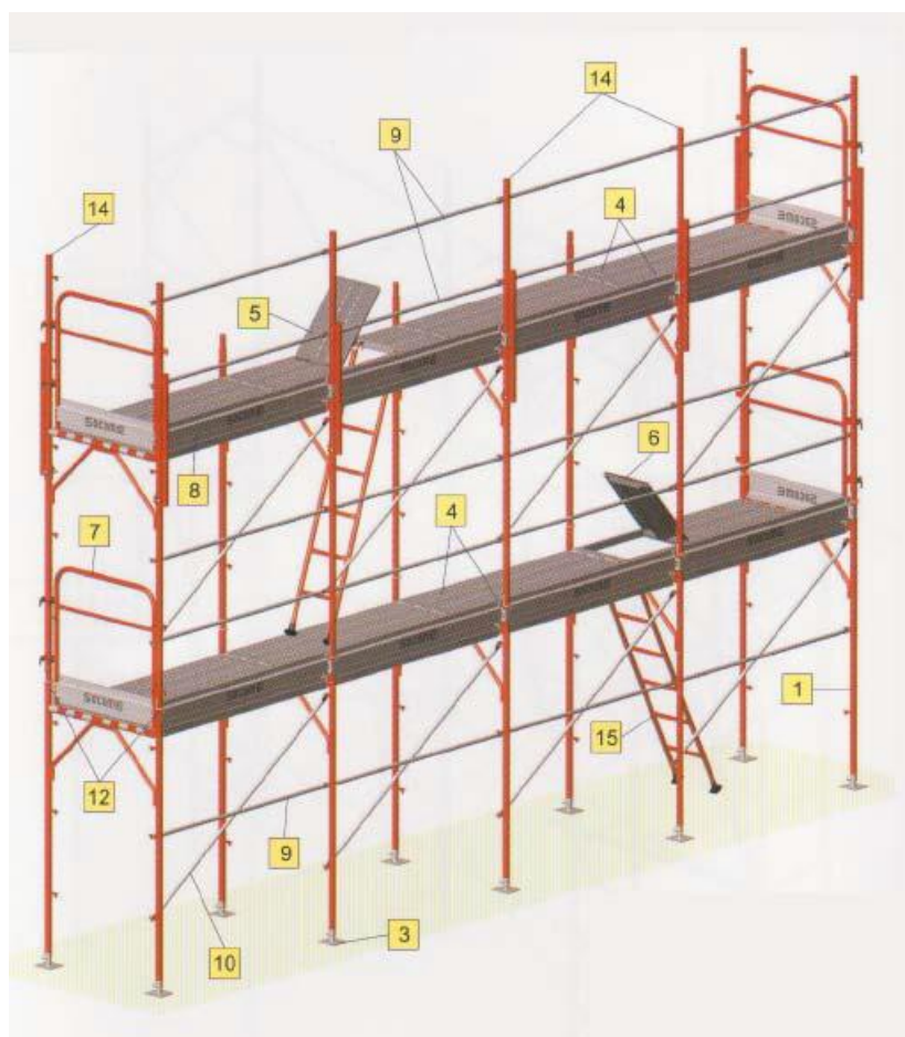
Ponteggio a telaio prefabbricato. Schema ponteggio a perni
