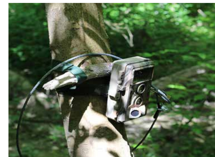
Figura 04.19. Una delle quattro fototrappole utilizzate nell'indagine: modello "DIGITNOW Trail Camera 16mp". [Alessandro Nardotto]
