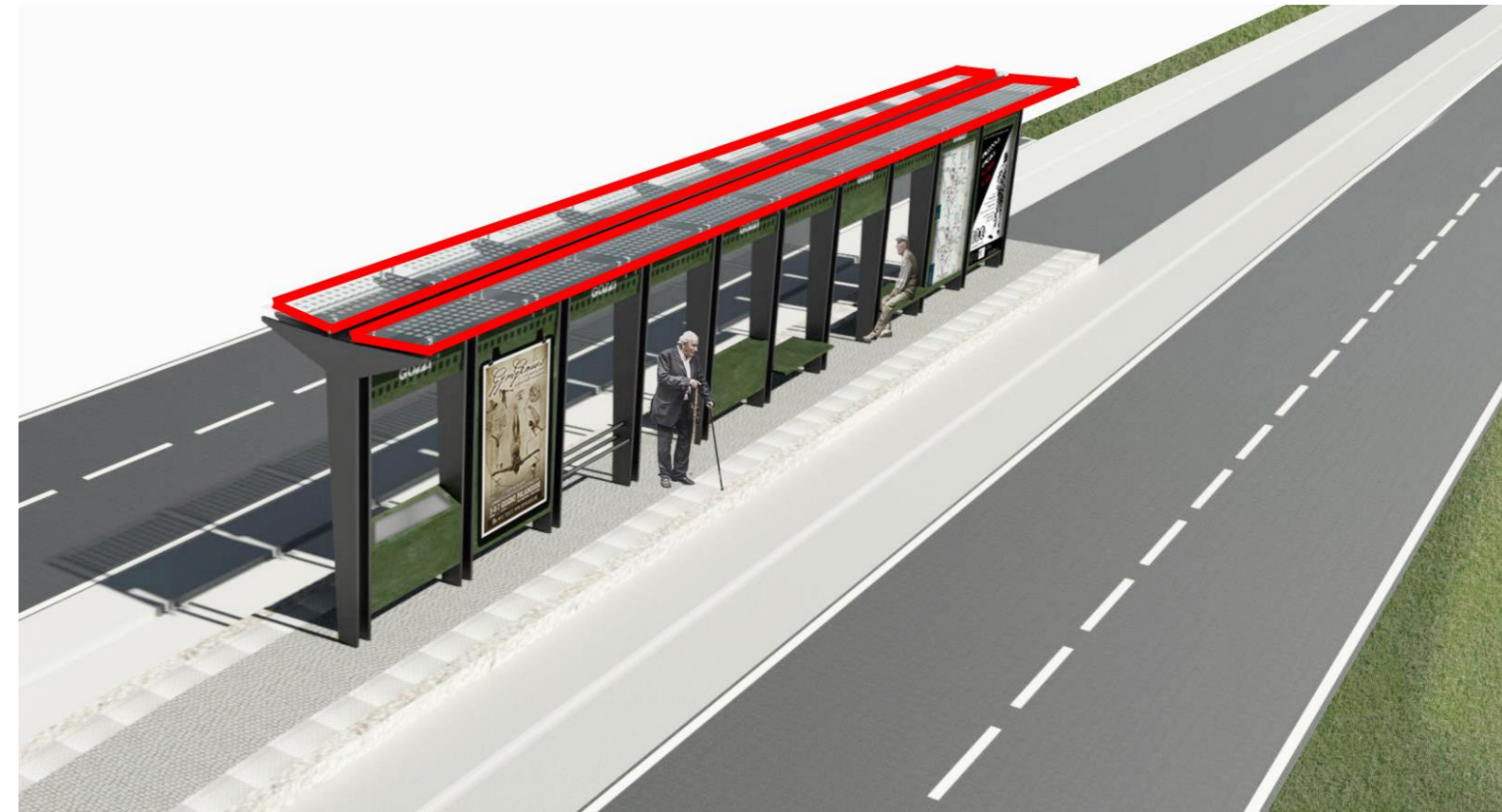
IMPIANTO FOTOVOLTAICO PENSILINA CENTRALE – VISTA 3D
