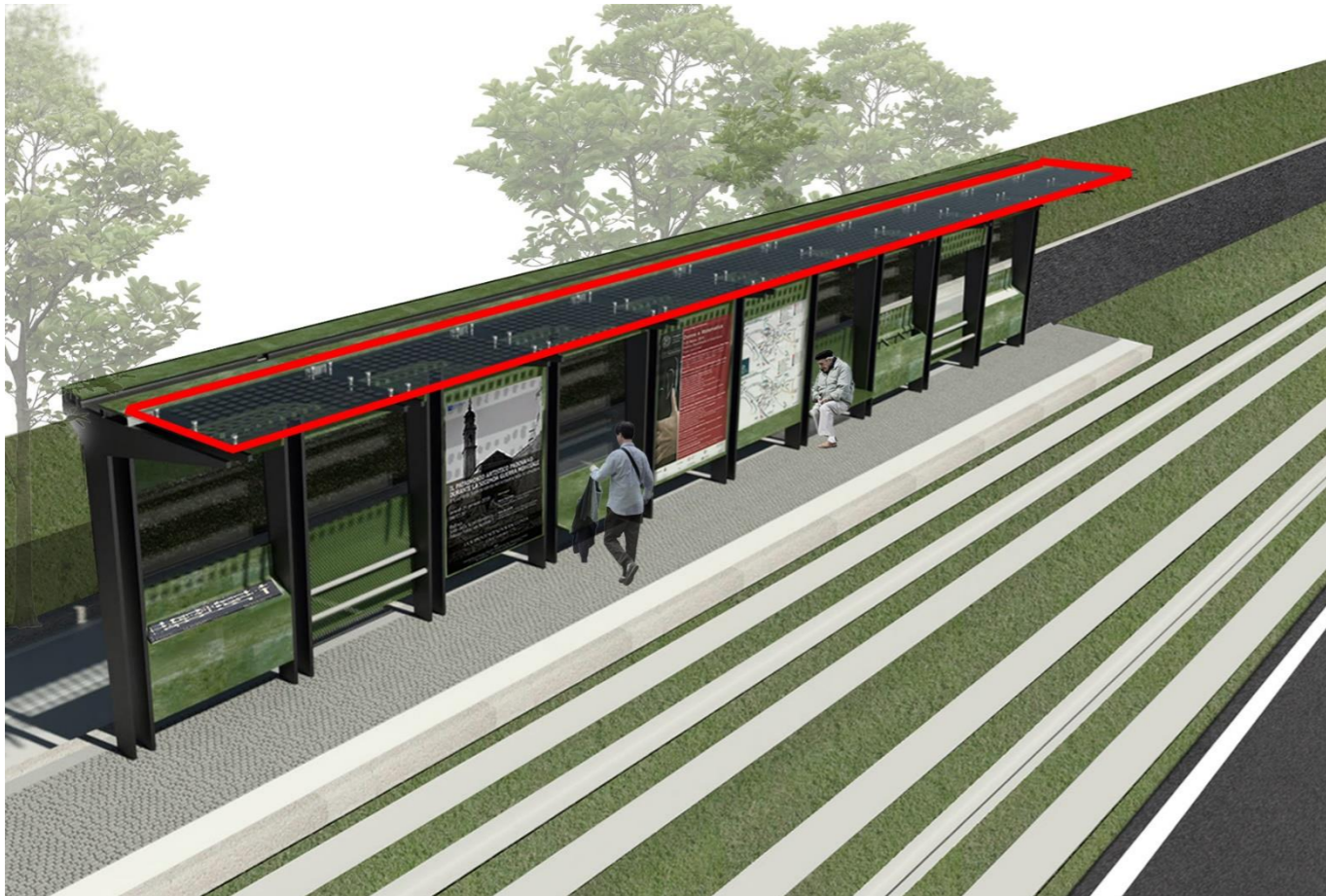
IMPIANTO FOTOVOLTAICO PENSILINA LATERALE – VISTA 3D
