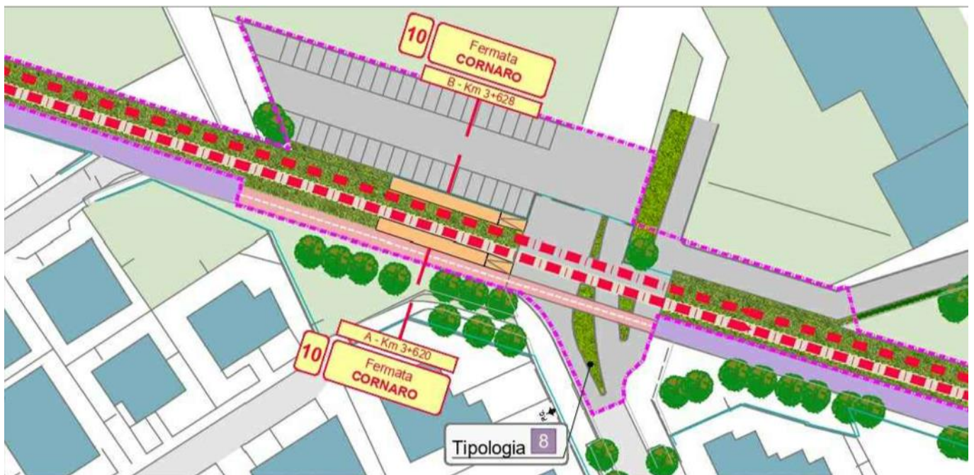
91. Tipologia 8: Sistemazione a verde spartitraffico - Cornaro
