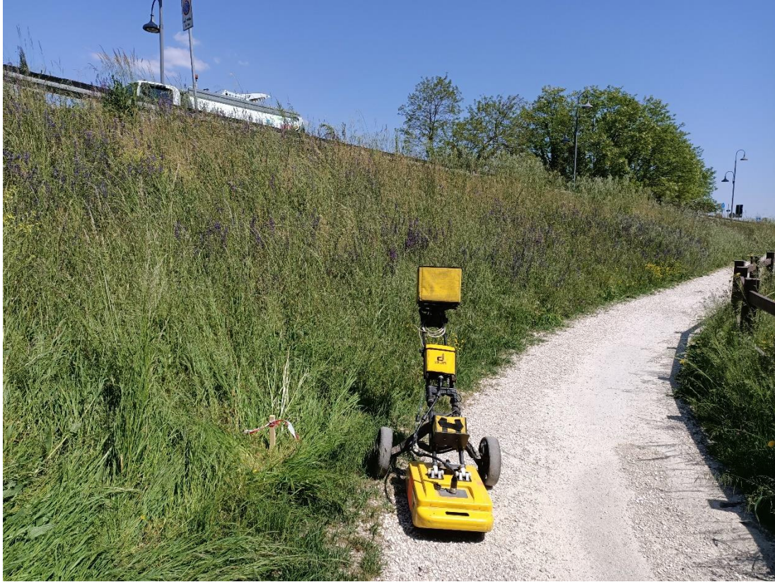
Figura 26 – Indagine georadar in corrispondenza del punto di indagine P2.
