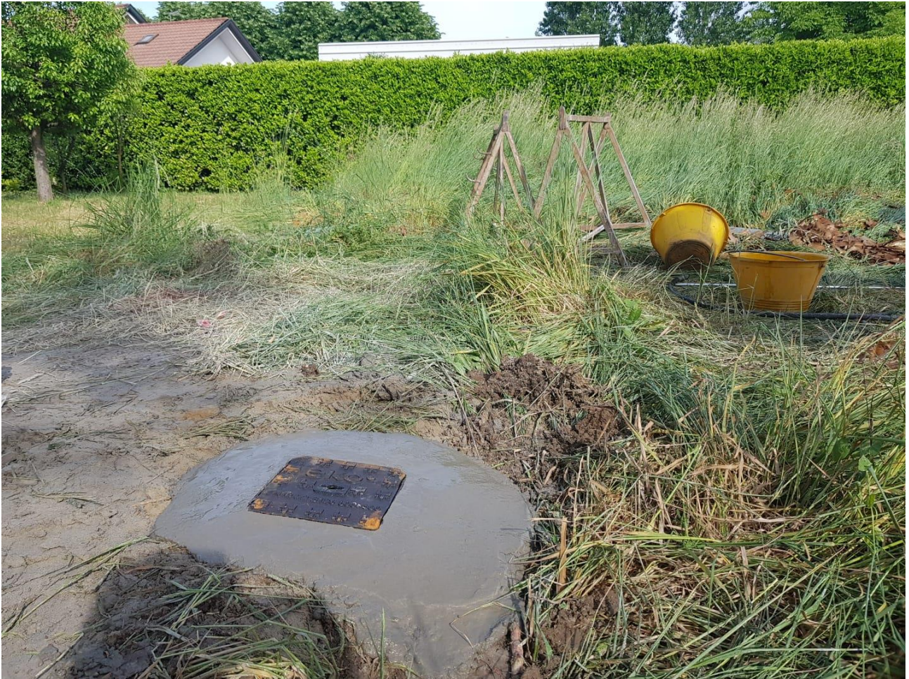
Figura 10 - Pozzetto carrabile in protezione del piezometro a tubo aperto installato nel sondaggio S1.
