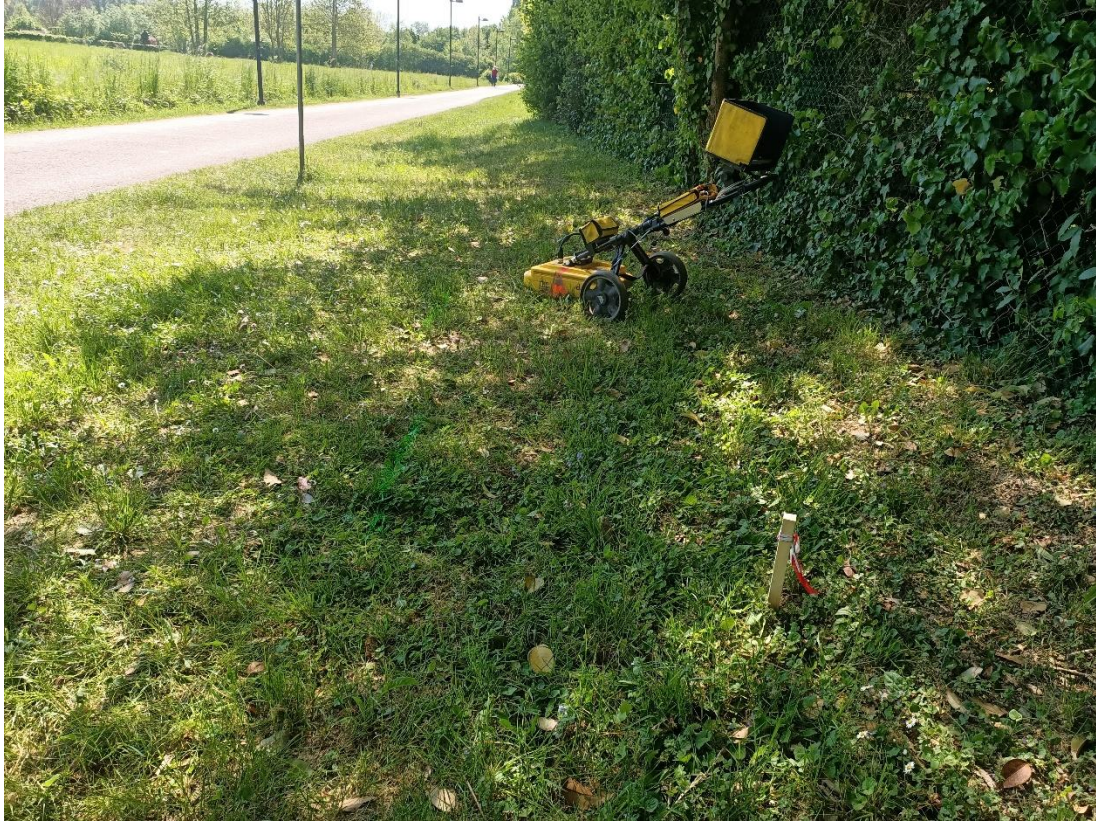
Figura 52 – Indagine georadar in corrispondenza del punto di indagine E6.
