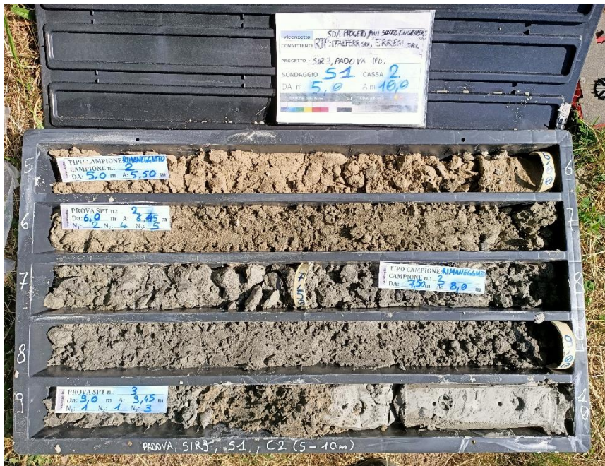
Figura 4 - Sondaggio S1, profondità 5,00-10,00 m.
