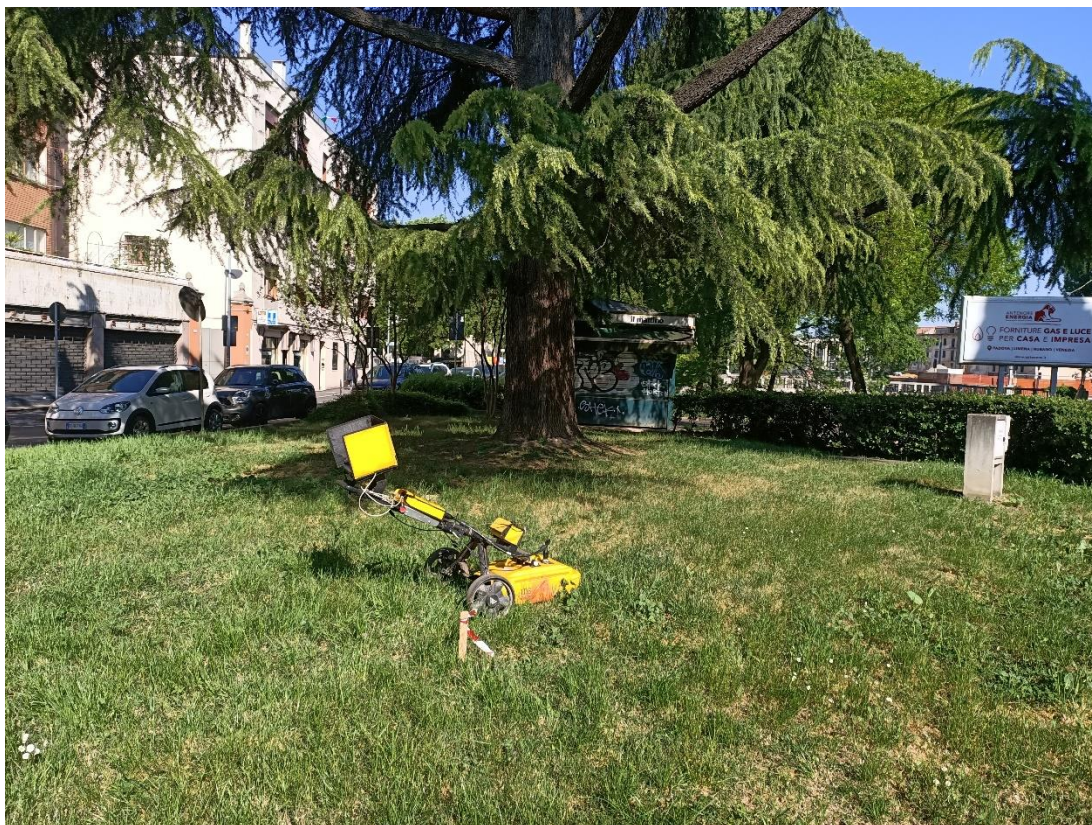
Figura 40 – Indagine georadar in corrispondenza del punto di indagine E2.
