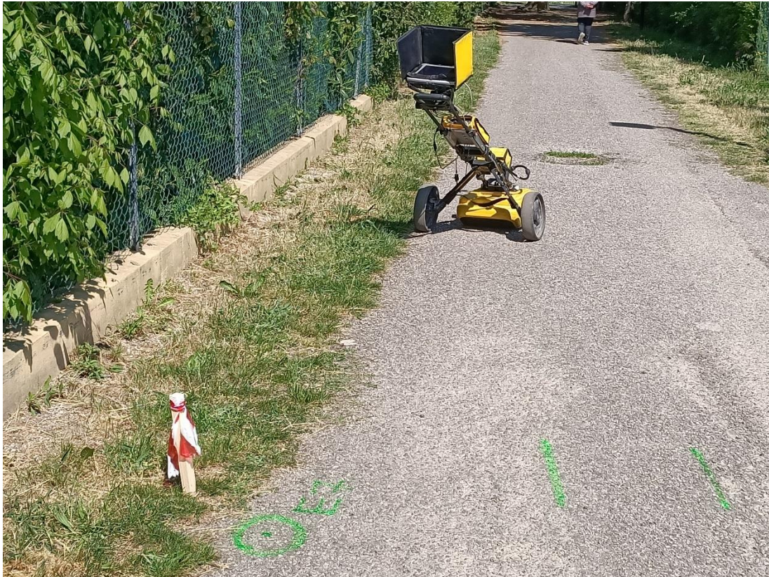
Figura 55 – Indagine georadar in corrispondenza del punto di indagine E7.
