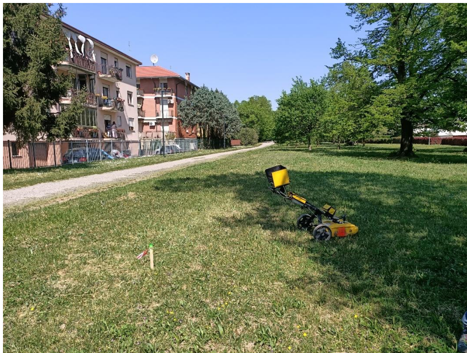
Figura 58 – Indagine georadar in corrispondenza del punto di indagine E8.
