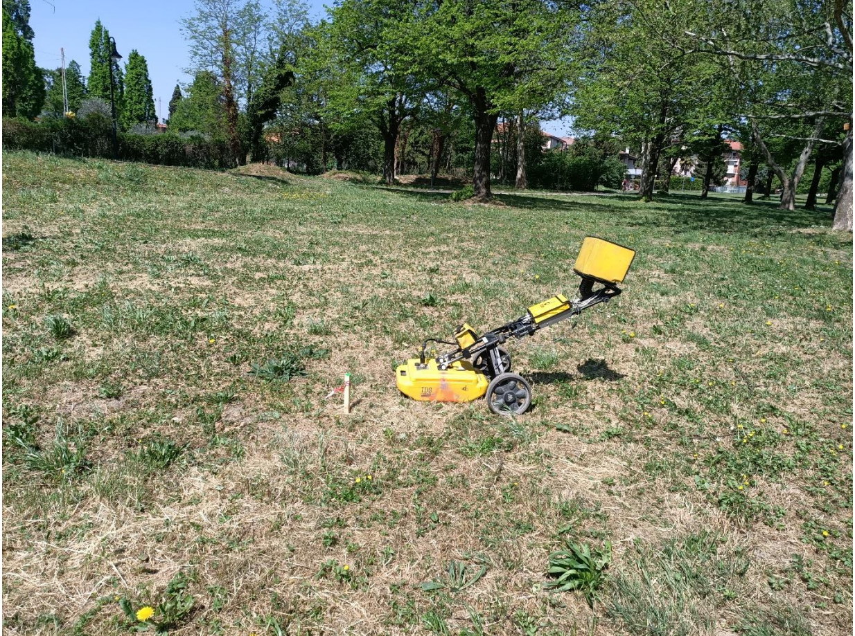
Figura 34 – Indagine georadar in corrispondenza del punto di indagine P5.
