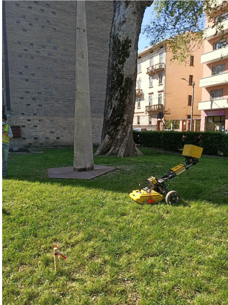
Figura 43 – Indagine georadar in corrispondenza del punto di indagine E3.
