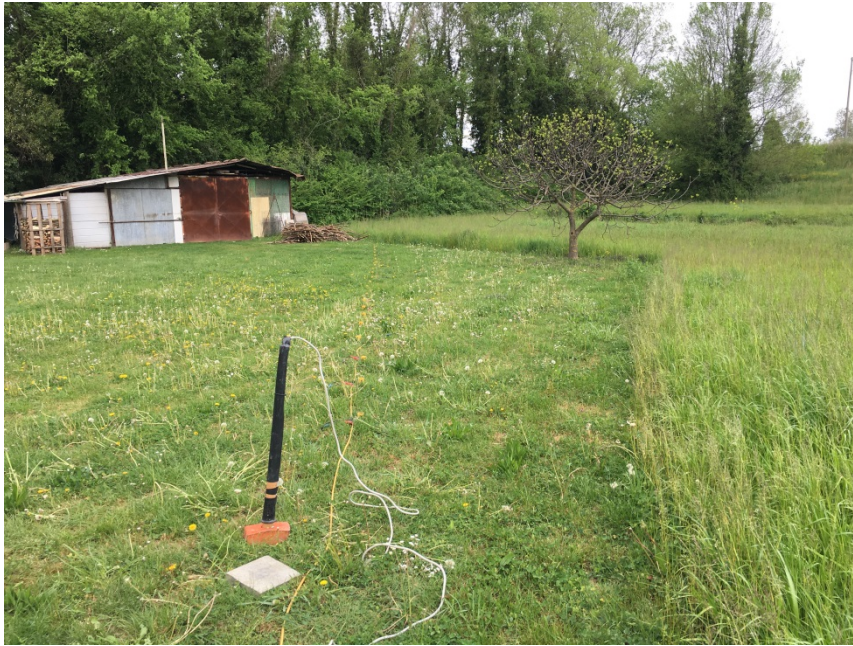
Strumentazione impiegata per le prove sismiche mediante metodologia MASW.
