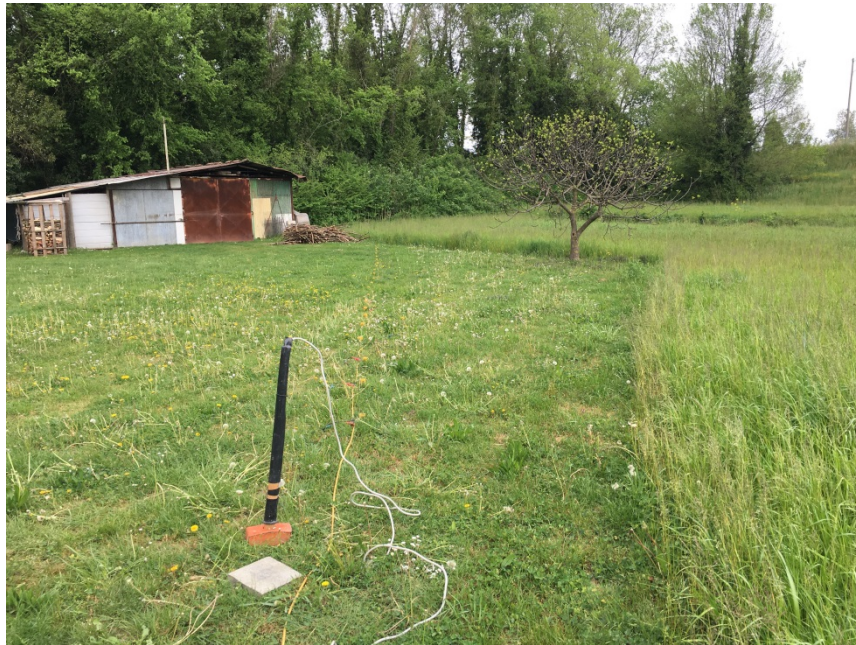
Foto relativa all' esecuzione della prova MASW SS1.
