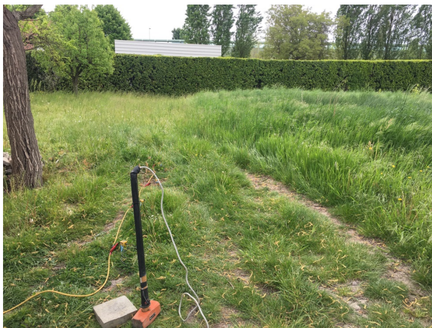
Foto relativa all' esecuzione della prova MASW SS2.
