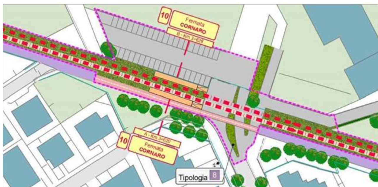
Figura 52 Tipologia 8: Sistemazione a verde spartitraffico – Cornaro
