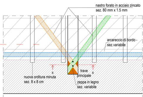
NOTA: L'orditura minuta sarà completamente sostituita con elementi in legno di classe C24 o superiore, di dimensione 8x8 cm, con interasse di 60 cm.
