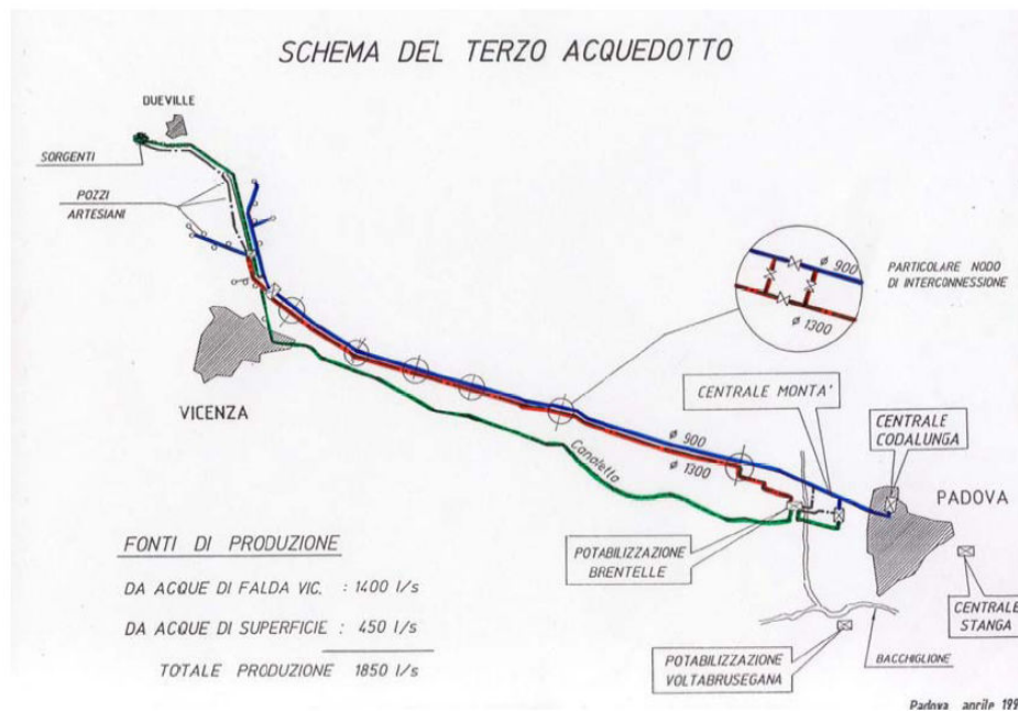
Figura 2-18 Schema del terzo acquedotto di Padova realizzato nell'anno 2000 (fonte: 2° Rapporto sullo stato dell'Ambiente nel Comune di Padova – 2006)
