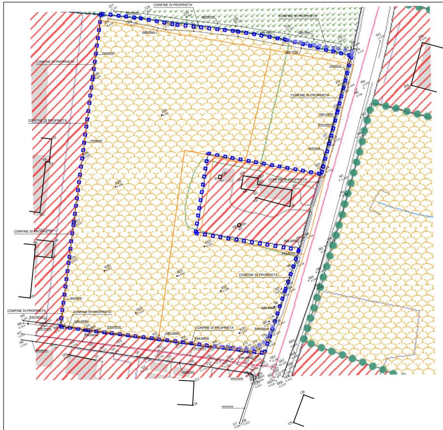
Rilievo Topografico con sovrapposizione P.R.G. - scala 1:500
