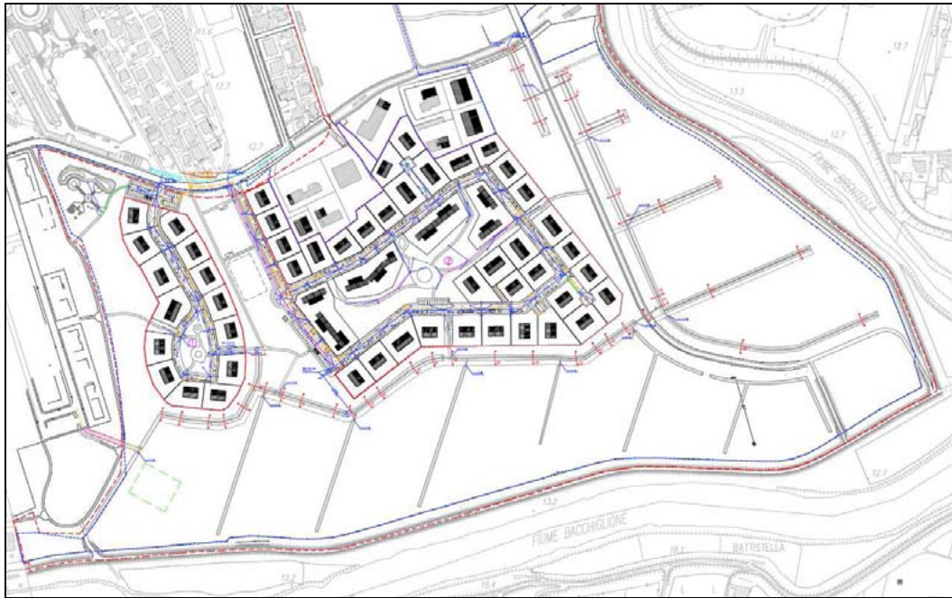
Figura 3. Planimetria della nuova rete di raccolta ed invaso delle acque di pioggia del Piano di Lottizzazione Brentella.
