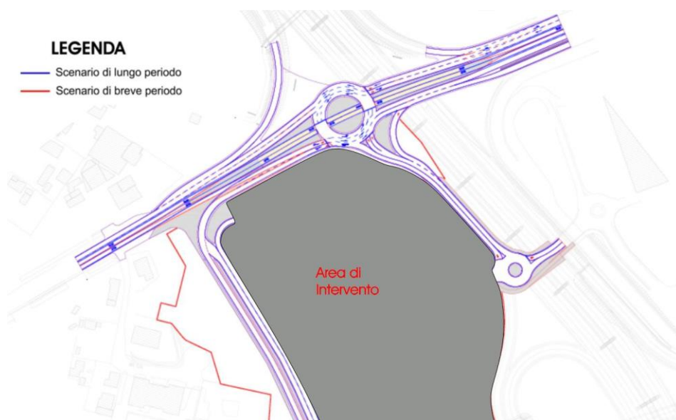
Figura 10.9 – Rotatoria lungo via San Marco – Confronto schema progettuale tra breve e lungo periodo
