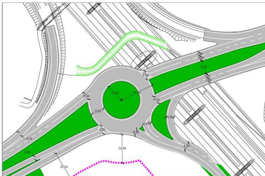
**Figura 46 – Rotatoria lungo via San Marco – Ipotesi 1 – Planimetria di progetto**
