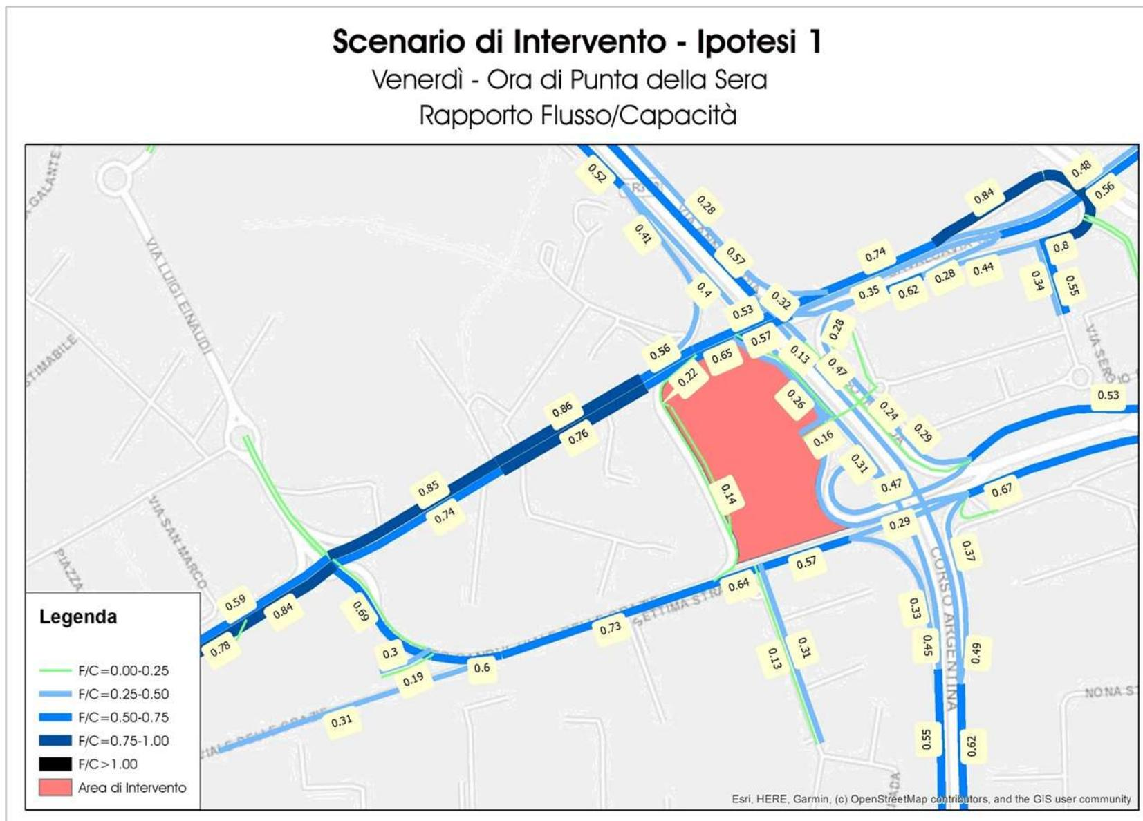
Figura 73 – Scenario di Intervento – Ipotesi 1 – Ora di Punta del Venerdì sera – Rapporto Flusso/Capacità
