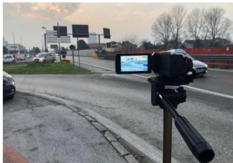
Figura 106 – Esempio di installazione per il rilievo di traffico con telecamere
