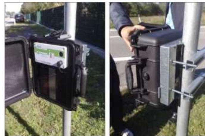
Figura 105 – RADAR SDR-Easydata – Esempio di installazione
