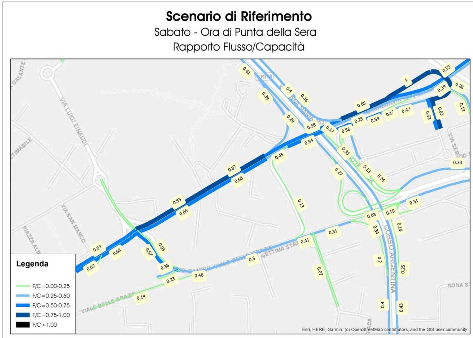
Figura 42 – Scenario di Riferimento – Ora di Punta del Sabato sera – Rapporto Flusso/Capacità
