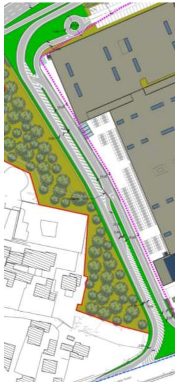
Figura 49 - Contro-strada lungo via Franceschini - Ipotesi 1 - Planimetria di progetto
