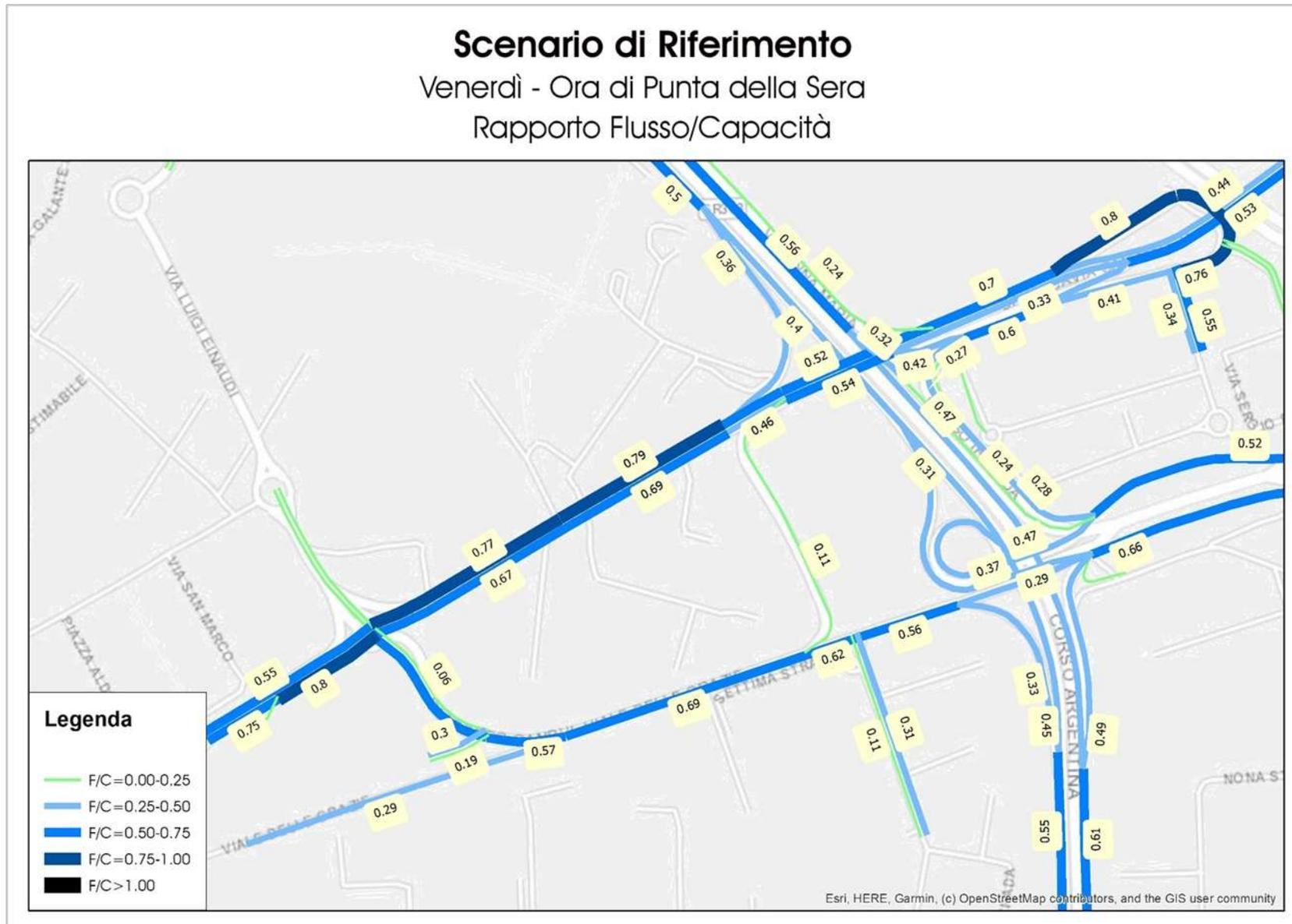
Figura 39 – Scenario di Riferimento – Ora di Punta del Venerdì sera – Rapporto Flusso/Capacità
