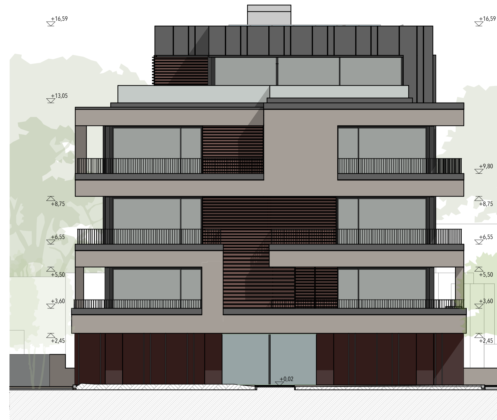
BLOCCO D - PROSPETTO EST - 1:100
