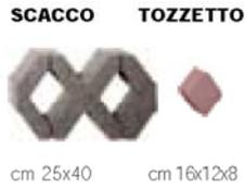
SCACCO è una pavimentazione grigliata, adatta al proprio completamento con terreno a semina di prato, sabbia o ghiaia, per ottenere una superficie carrabile verde. Integrabile, nello spessore da 8 cm, con l'elemento TOZZETTO a riempimento della griglia, per ottenere una pavimentazione continua.
