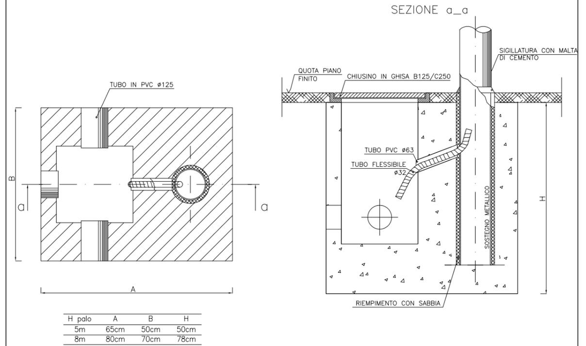
Plinto in cls vibrato di tipo prefabbricato, completo di pozzetto dim 30x30 cm con chiusino in ghisa C250 su aree con transito di veicoli e B125 su aree a parcheggio e aree verdi. Il plinto sarà dimensionato secondo norme UNI NTC del 2008 DM 14.01.2008 per zone tipo 1 e 2 per pali rispettivamente fino a 5 m e 8 m di altezza fuori terra.
