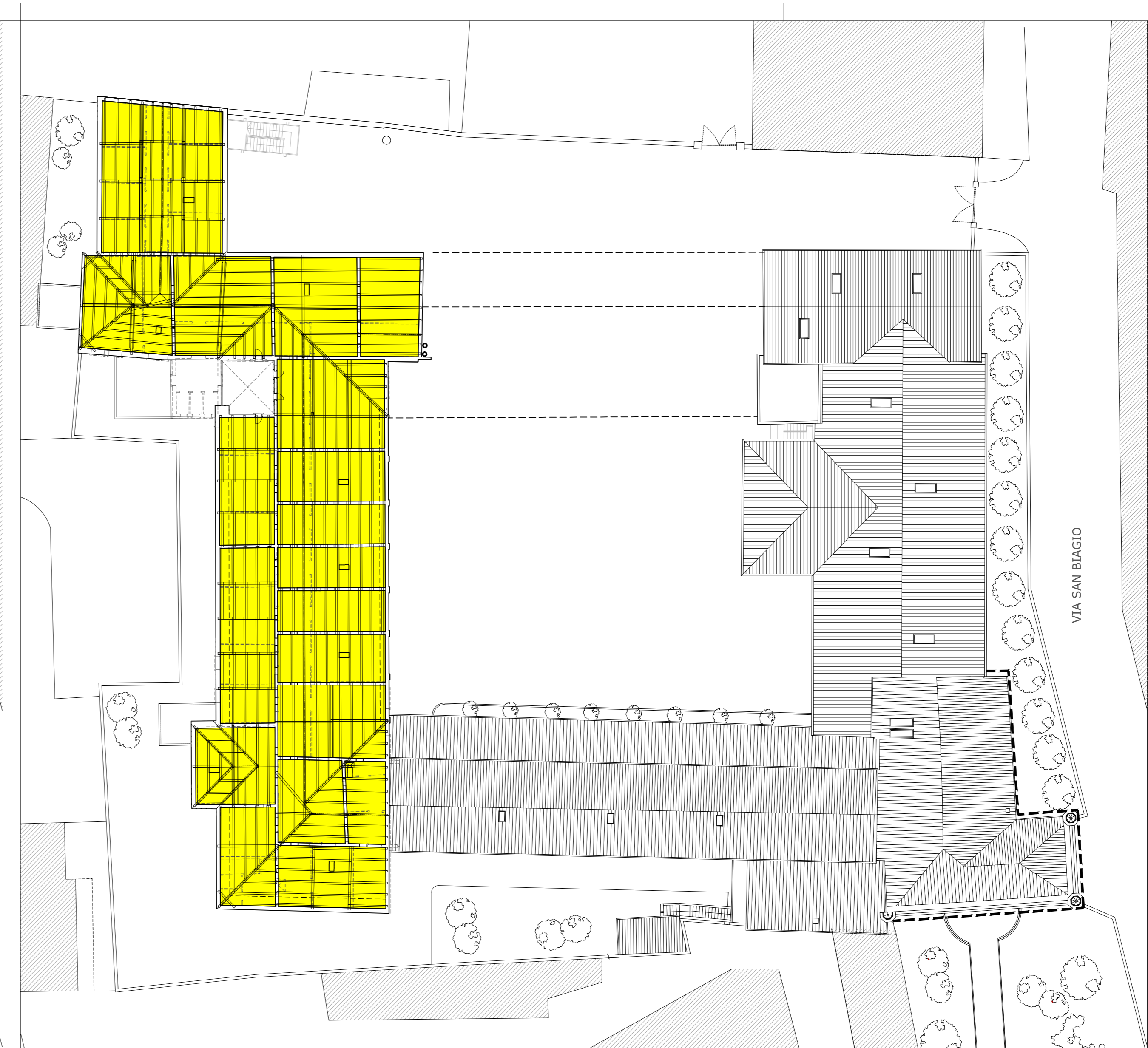
PIANTA PIANO TERZO E ORDITURA LEGNO COPERTURA
