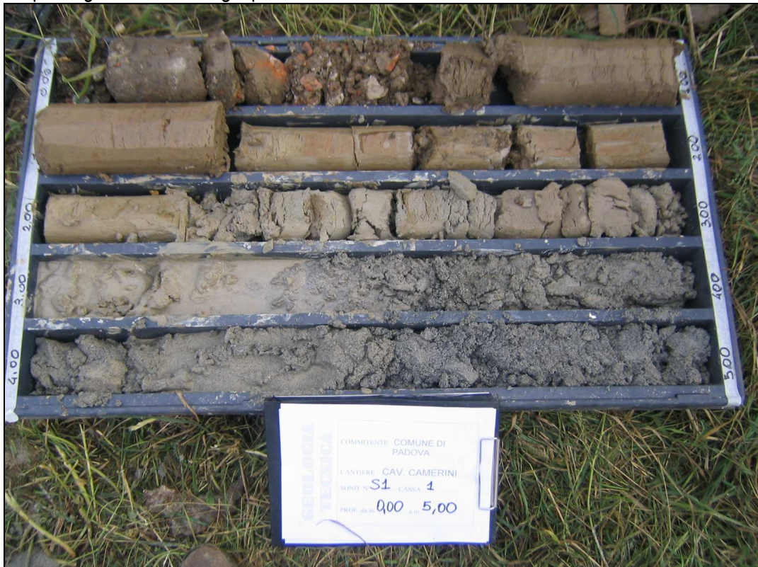
Foto della cassetta catalogatrice del sondaggio S1 con le litologie da 0.0 a 5.0 m p.c.; area Cavalcavia Camerini
