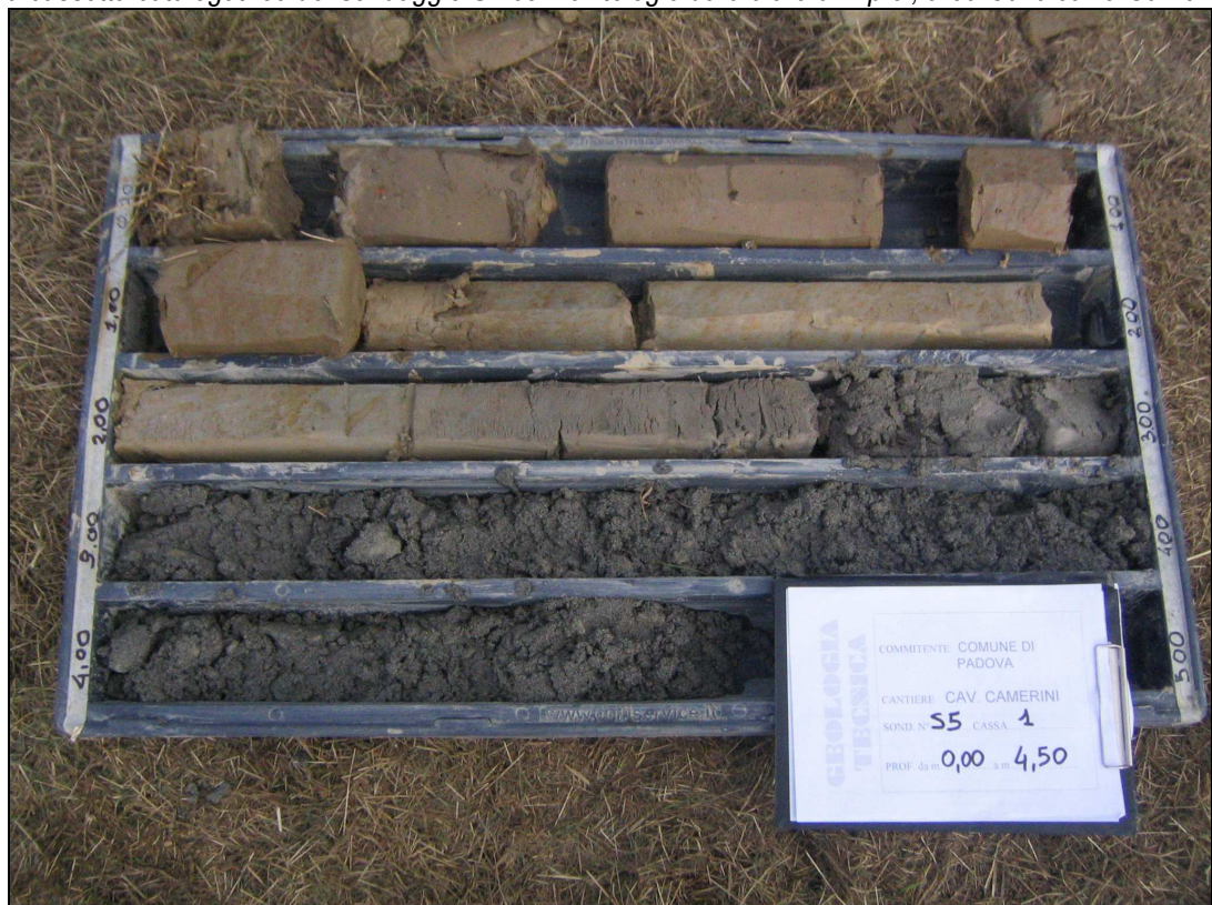
Foto della cassetta catalogatrice del sondaggio S5 con le litologie da 0.0 a 4.5 m p.c. ; area Cavalcavia Camerini
