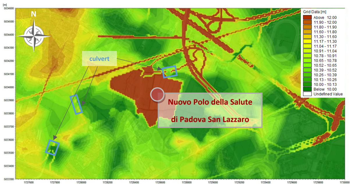
Figura 5.13 – Zoom batimetria del modello idraulico; in evidenza, la configurazione di progetto inserita (quote del terreno in m s.l.m.).
